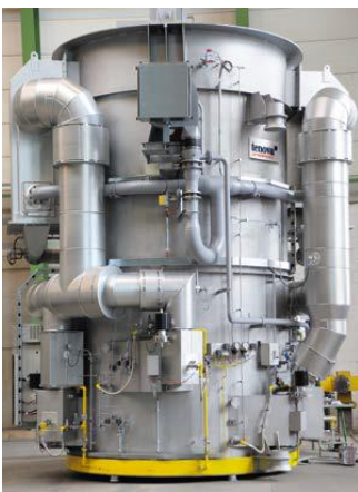
Bild 1: Tenova LOI Thermprocess Ultra low NO x HPH®-flameless Heizhaube bei thyssenkrupp Hohenlimburg
