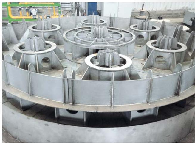
▲ 根据有限元强度模型设计的炉台，装备有固定装料位，保证了极高的稳定性
