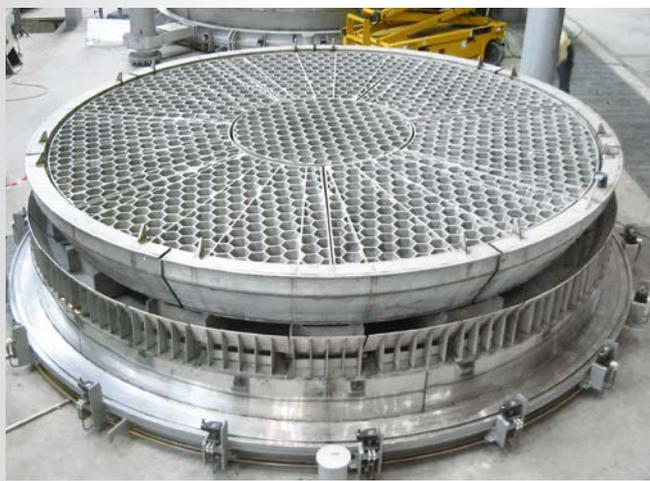
▲ 退火炉台适用于氮气和氢气退火，采用耐热钢材质的蜂窝板和导流/扩散器设计
