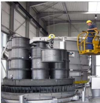
▲ 拉拔线轴的装料方式
