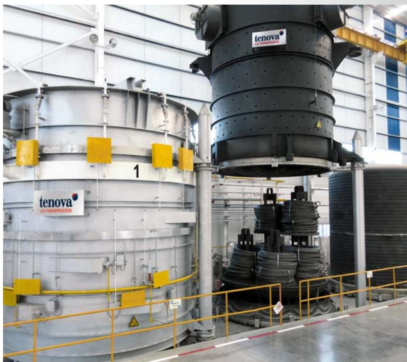
▲ 冷镦钢线材的HPH®罩式退火炉
