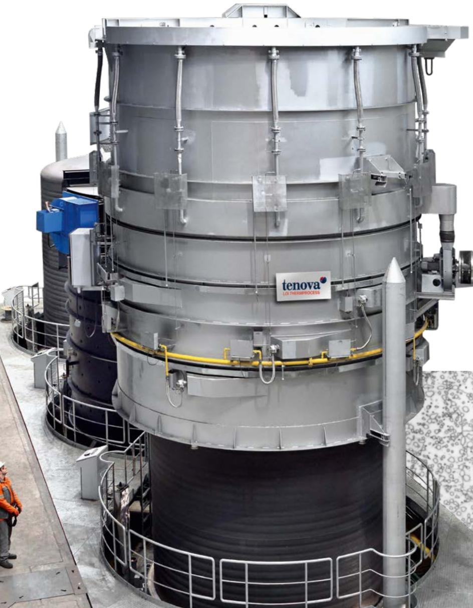
◀ HPH®加热罩放置在带导流筒的内罩外。
