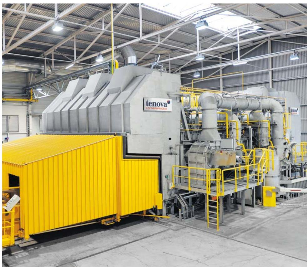
◀ Zweikammer-Schmelzofen TCF® mit automatischer Chargiermaschine CM
