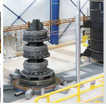
▲ Einstapel-Anordnung von Drahtbunden
