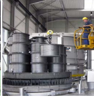
▲ Glühen von Ziehdraht auf Spulenkörpern
