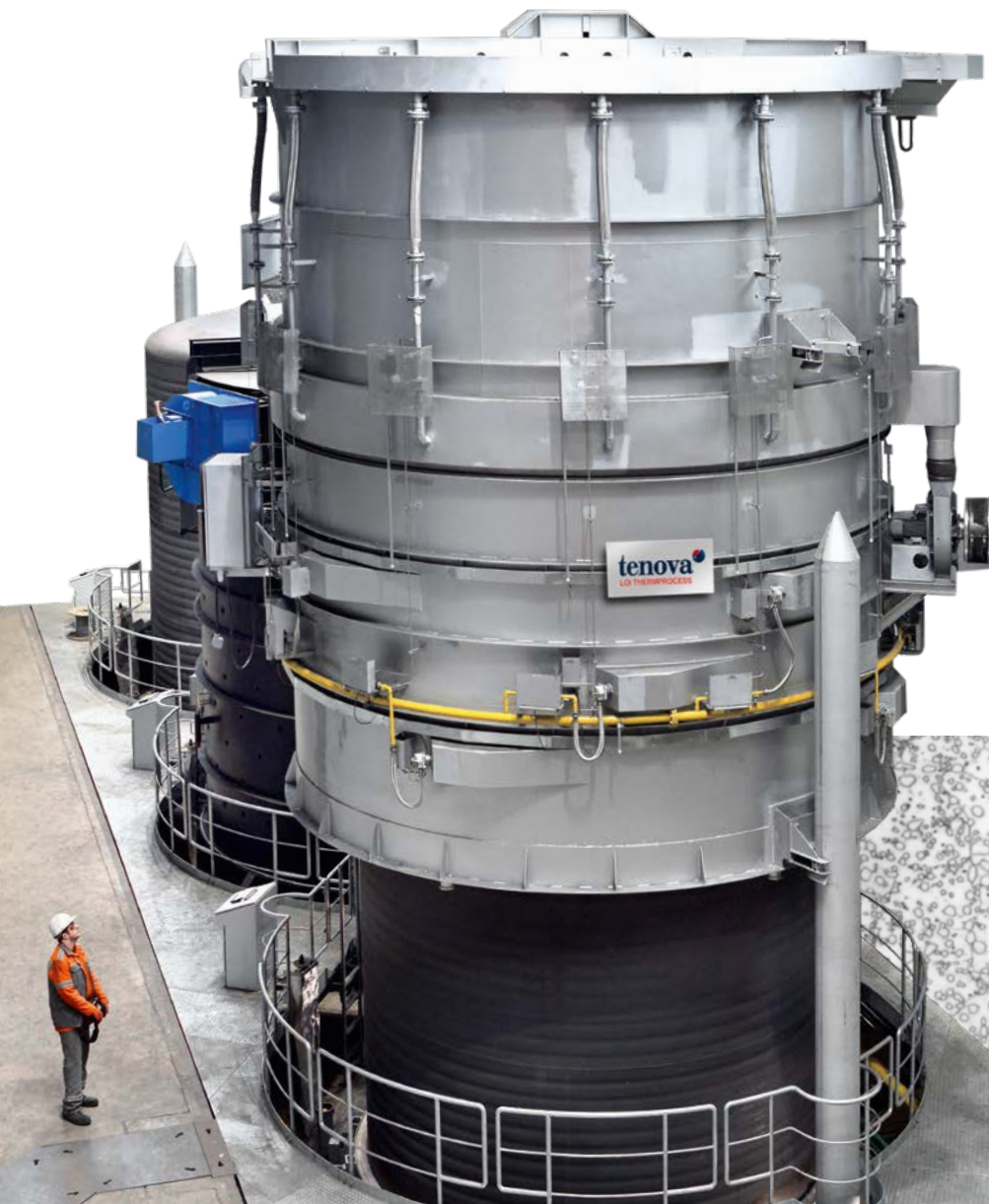
▲ Tangentiale Anordnung mit 12 Brennern auf drei unterschiedlichen Ebenen. Jeder Brenner hat die Leistung von 150 kW. Alle Brenner sind mit individuellen Rekuperatoren ausgestattet. Ein Spezialbrenner dient der Nachverbrennung von H_2 und Ziehmittel-Rückständen.
