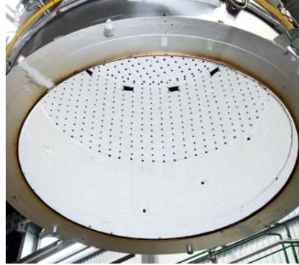
▲ Tangentiale Anordnung mit 12 Brennern auf drei unterschiedlichen Ebenen. Jeder Brenner hat die Leistung von 150 kW. Alle Brenner sind mit individuellen Rekuperatoren ausgestattet. Ein Spezialbrenner dient der Nachverbrennung von H_2 und Ziehmittel-Rückständen.
