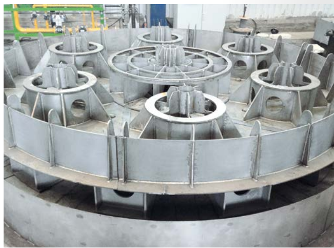
▲ FEM optimiertes Sockeldesign mit festen, hoch belastbaren Chargierplätzen
