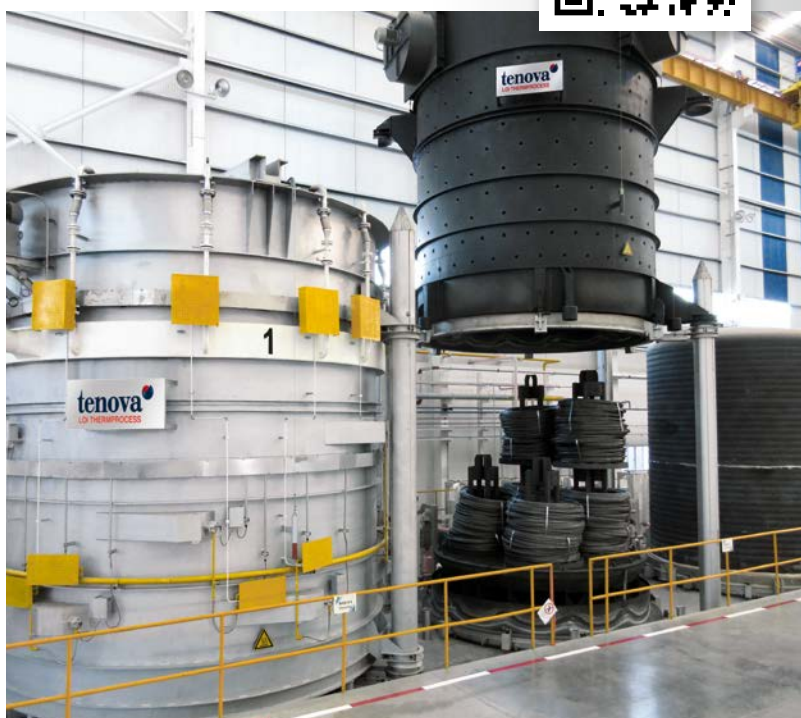
▲ HPH® Haubenofenglühanlage zur Wärmbehandlung von Kaltstauchdraht
