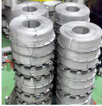
▲ Glühen von Flachdraht
