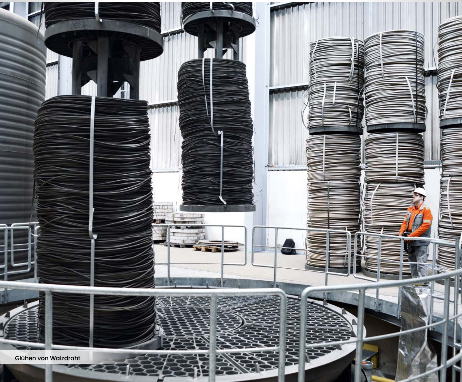
▲ Glühen von Ziehdraht auf Spulenkörpern
