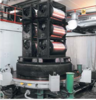
▲ Glühen von Buntmetalldraht
