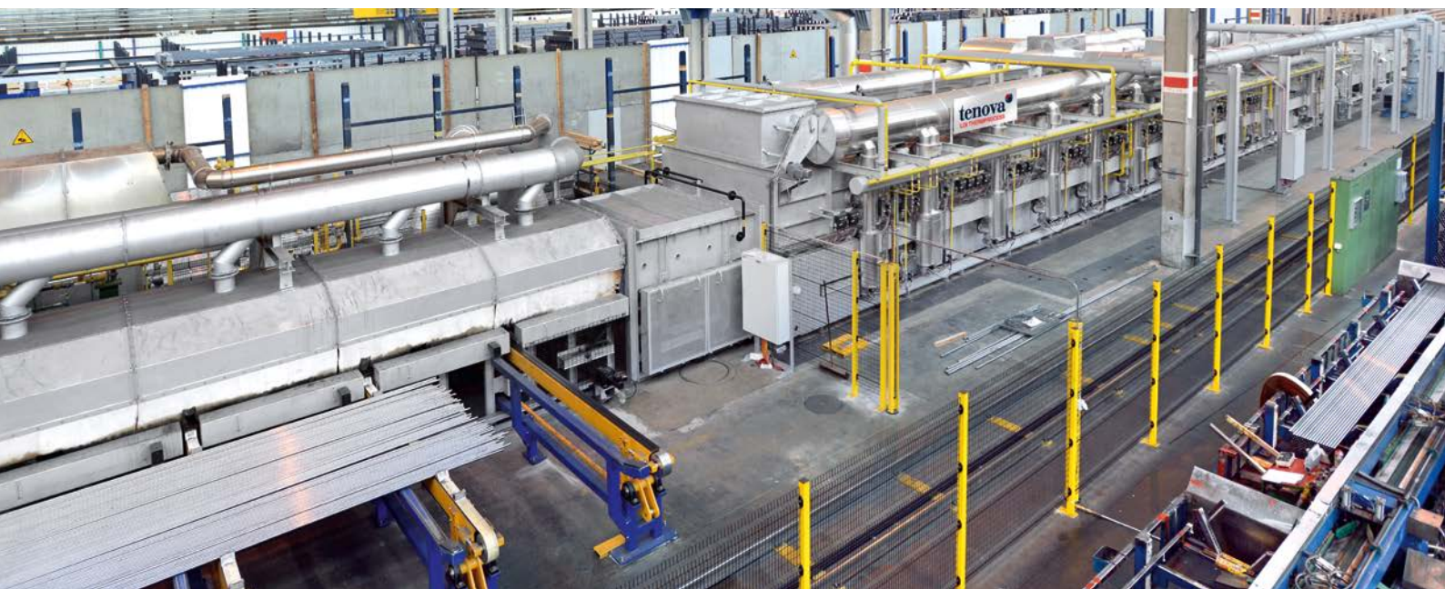
▼ Schutzgas-Rollenherdofen RoDR 7000 mit geschlossenem Abgassystem
